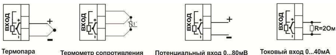
Рисунок 6 – Схемы подключения датчиков
